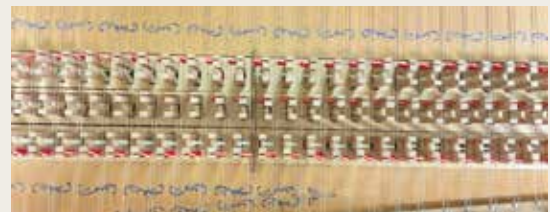
(上列)下鍵盤8フィート (中列)下鍵盤4フィート (下列)上鍵盤8フィートのジャックが並んでいます。
